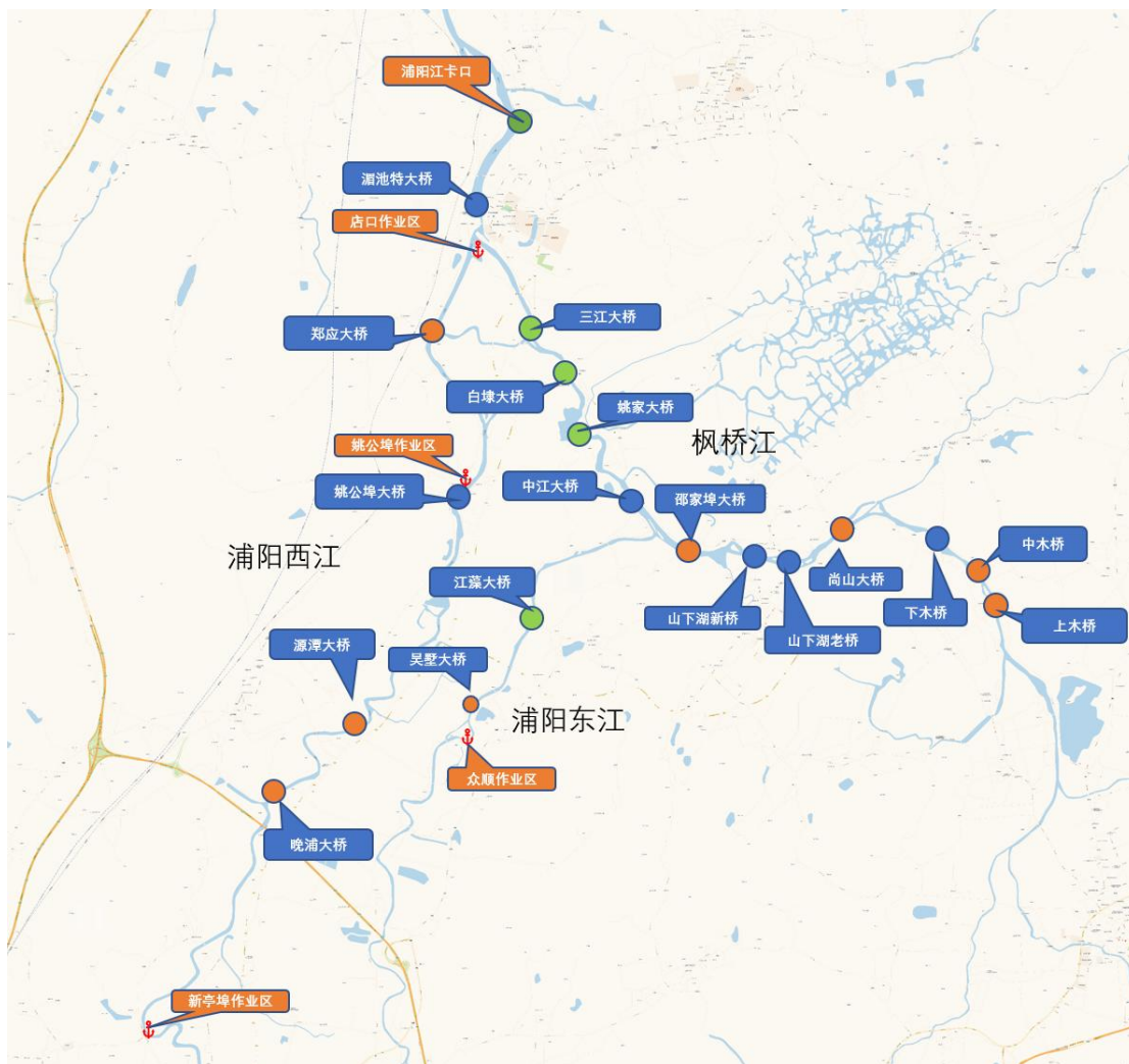
图 1-1 诸暨多桥联动桥梁防船撞主动预警系统桥梁分布图
