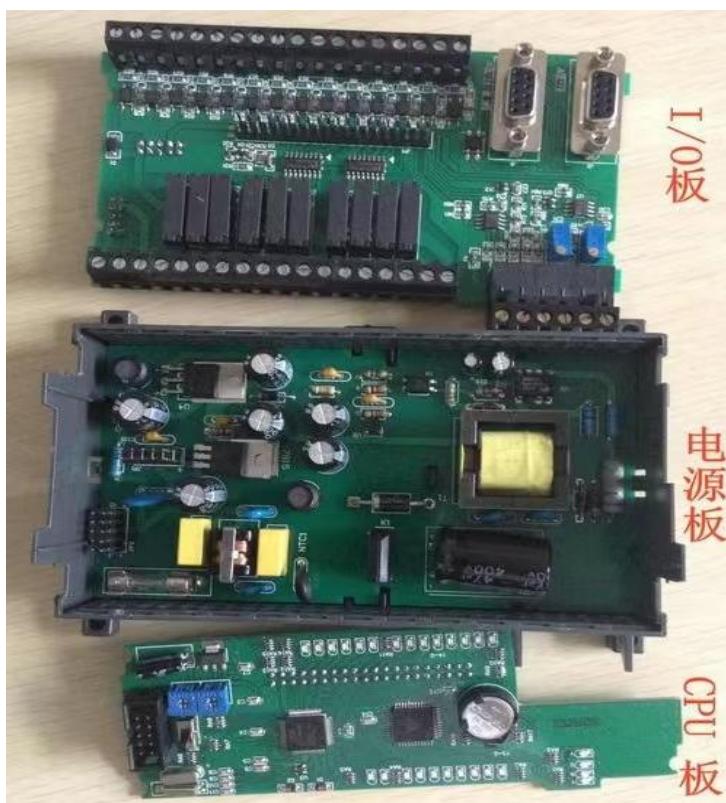
西门子 PLC S7-200 电路板图
