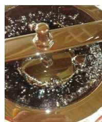
图 3 燃油分油机输送泵滤器状况
