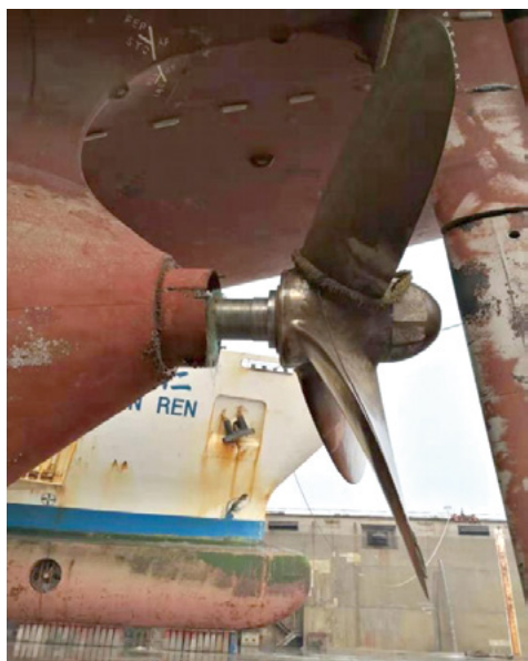
图7 螺旋桨轴船体外侧变形情况
