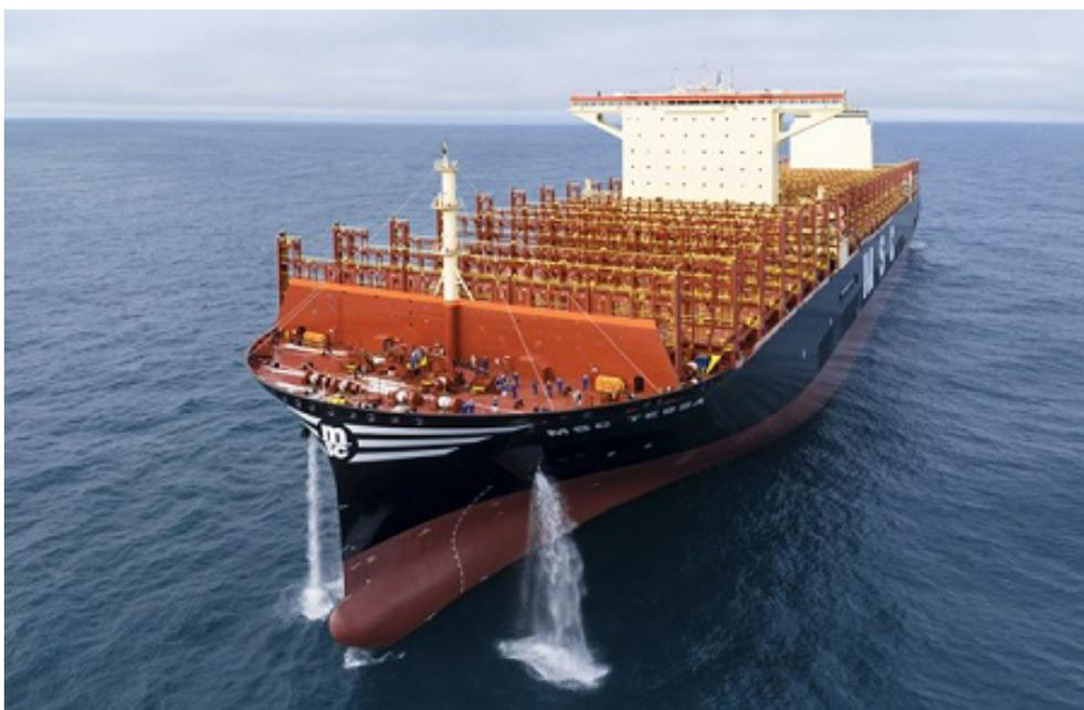
相应总量 3%-4% 的碳排放，全年可减少 6000 多吨。首次采用轴带发电机系统，能够有效降低燃油消耗，优化油耗和船舶能效设计指数（EEDI），减少温室气体排放。
