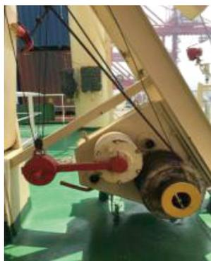
图 3 救生艇绞车控制装置
