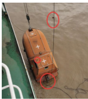
图1 艇内降落钢丝重力块下钢丝绳断裂
