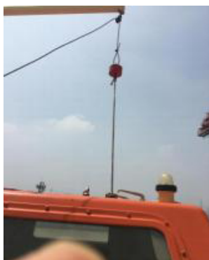
图4 艇内降落控制钢丝
