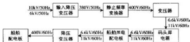
图 3.1 高压电源、低压供船示意图
