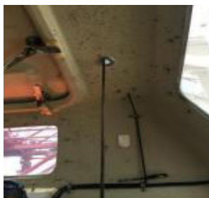
图7 艇内控制钢丝未装拉环
