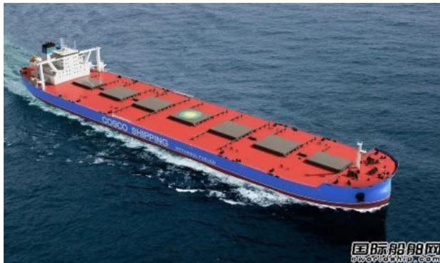
该船型是在中远海运集团联合创新工作室的持续推动下，由中远海运散运、中远海运重工等联合开发的船型，是目前世界最大最先进的甲醇双燃料矿砂船，技术含量和绿色环保性能高。
