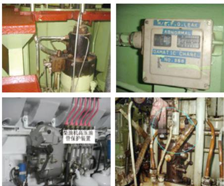
2.2 液位式（浮子式、电极式、电容式、红外线感光式、超声波式）：
