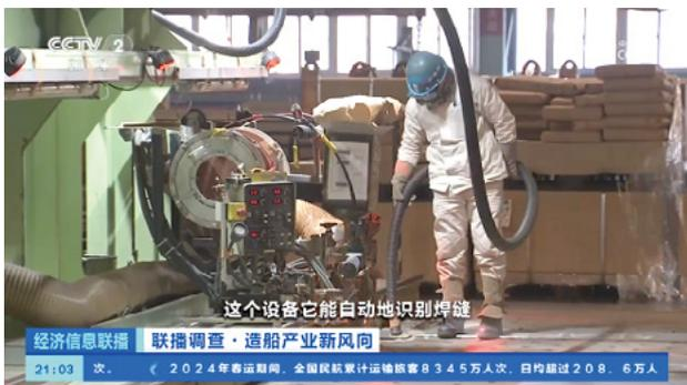
大连中远海运川崎副总经理许迎春：这条线是我们机器人的一个自动焊接线。这个设备它能自动地识别焊缝，它的效率大概是人工焊接的2.5倍到3倍的样子。
