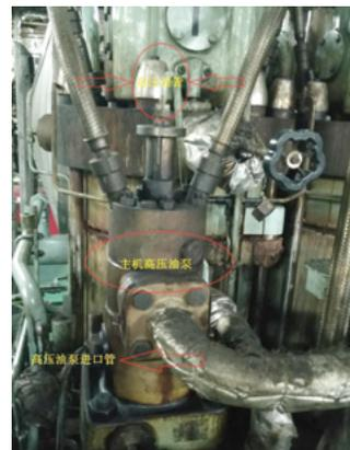
2.1 压力式：在收集漏油的装置中，当漏油达到一定时，通过压力传感器将这一压力信号转化为电信号输送到集中声光报警显示器上，发出燃油泄漏声光报警。
