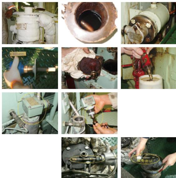
2.3 感应式: 在收集漏油的装置中, 当漏油达到一定时, 通过感应式探头将燃油泄漏这一信号转化为电信号输送到集中声光报警显示器上, 发出燃油泄漏声光报警。
