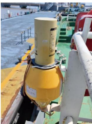
救生圈自发烟雾信号，确切的说应该叫做自亮灯及自发烟雾信号，和救生圈组合在一起，安装在驾驶台两翼，通常各有一只比较特殊的救生圈存放在快速释放箱内，这个救生圈全称是“带自亮灯和自发烟雾信号救生圈”，再加上一个快速释放装置，就叫做“自亮灯和自发烟雾信号救生圈快速释放装置”，通常简称有“组合烟雾信号救生圈”、“MOB”等。
