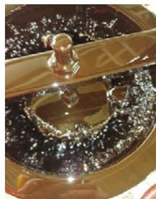
图 2 燃油分油机输送泵过滤器状况
