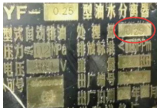
图4 油水分离器的处理量 0.25m 3 /h
