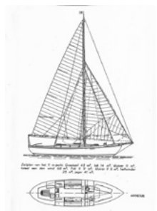
“安娜·伊丽莎白”号帆船设计图和线描图
