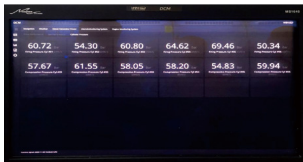
图 1 气缸压力动态监测
