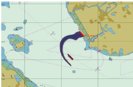
图8 靠泊 4# 泊位运动轨迹图 (15 万吨级、风力 6 级, 风向 220°)
