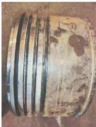
图3 活塞头各环槽磨损出现台阶
