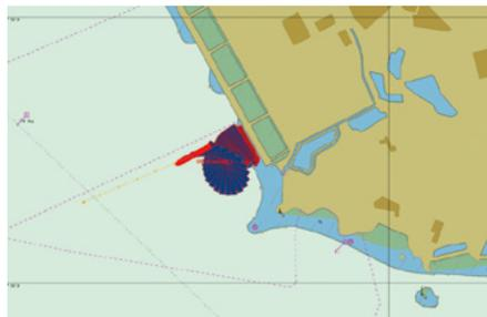
图10 离泊 5# 泊位运动轨迹图 (10 万吨级、风力 6 级, 风向 240°)
