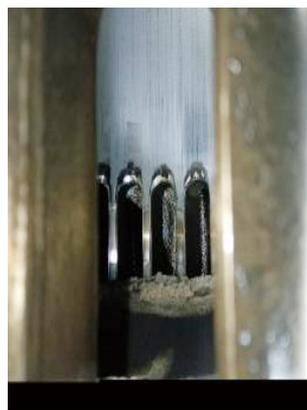
图5 内壁衍磨纹消失
