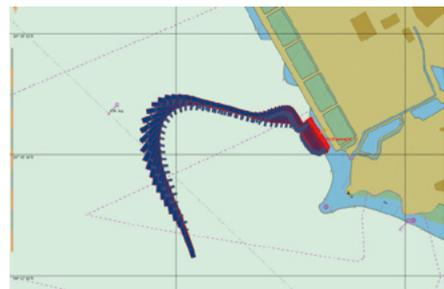
图 6 靠泊 5# 泊位运动轨迹图 (10 万吨级、风力 6 级, 风向 060°)
