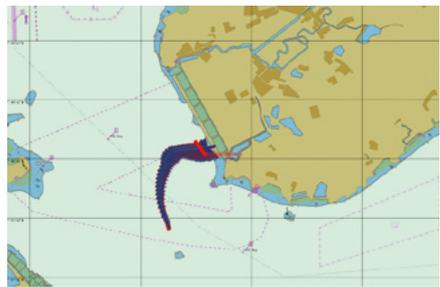
图9 靠泊 5# 泊位运动轨迹图 (15 万吨级、风力 6 级, 风向 220°、失败)
