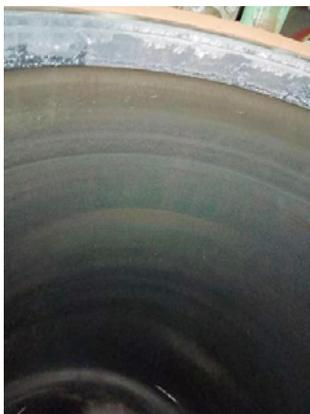
图1 缸套顶部内壁磨出磨台
