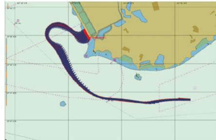
图 5 靠泊 5# 泊位运动轨迹图 (10 万吨级、风力 7 级, 风向 290°)
