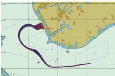
图7 靠泊 3# 泊位运动轨迹图 (15 万吨级、风力 7 级, 风向 290°)
